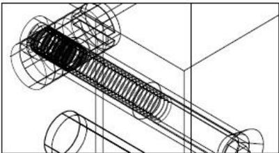
**4 x 2 (gesamt 8 x) Quermutterbolzen und M6 x 60 Zylinderkopfschrauben**
